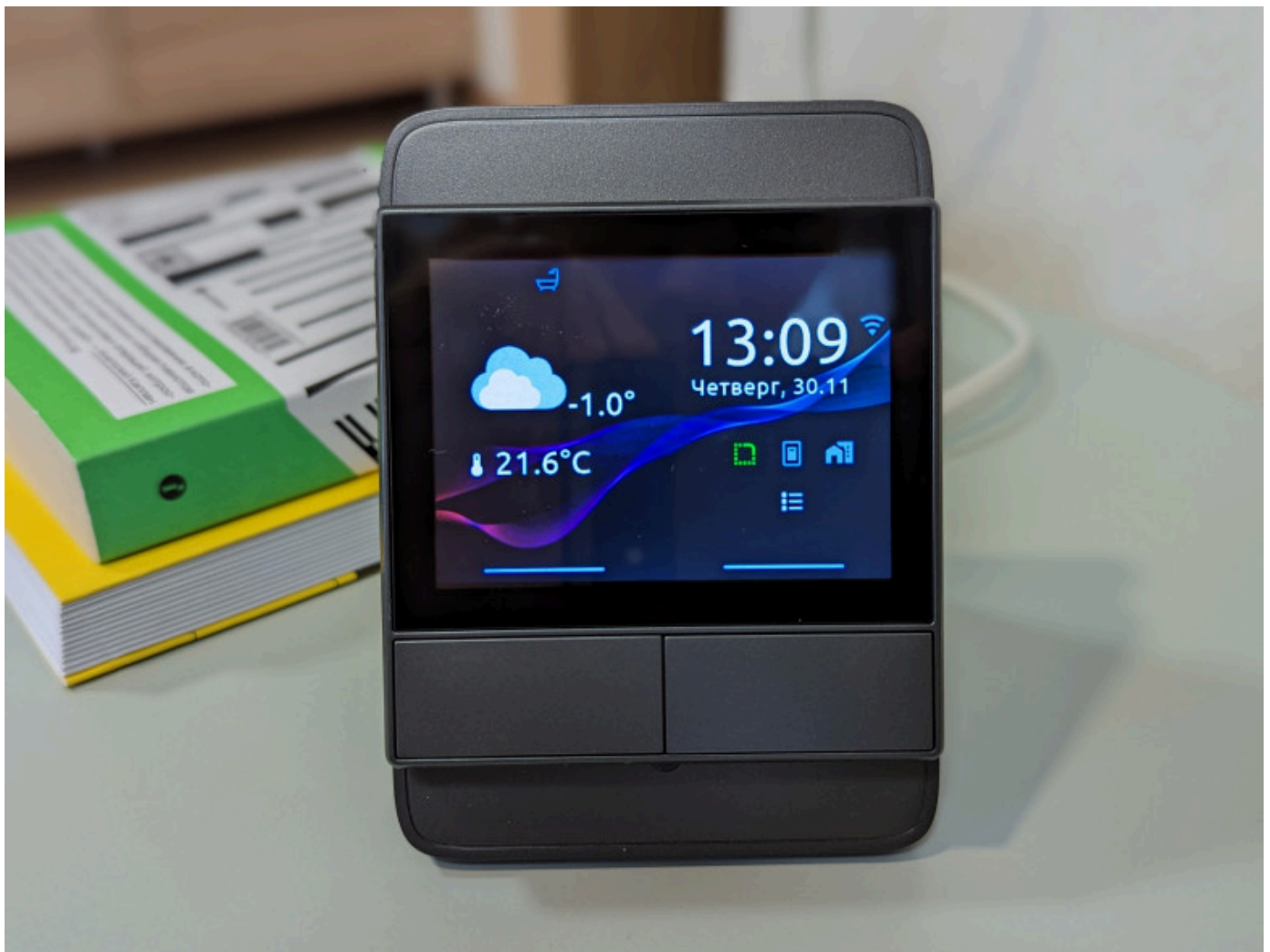
Sonoff NSPanel - это Wi-Fi панель с контроллером ESP32 и дисплеем Nextion, перепрошитая и отвязанная от китайских сервисов
